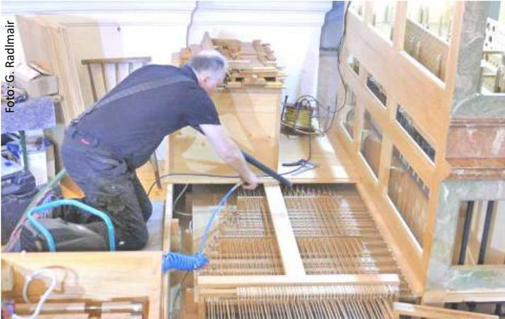
Orgelbauer Ekkehard Fehl bei der Reinigung der Traktur, des Übertragungssystems zwischen Tasten und Registern des Spieltisches und dem Ventilsystem der Windlade unter den Pfeifen.
